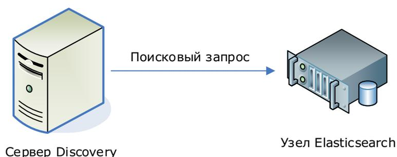
Установка агента DeviceLock Discovery на узел Elasticsearch не производится. Обнаружение выполняется путем прямого HTTP-доступа к узлам Elasticsearch. Действия при обнаружении ограничиваются протоколированием событий и отправкой оповещений. Сервер Discovery не может изменять и удалять документы в Elasticsearch.
