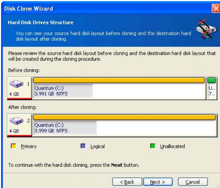
En regard du numéro de disque dur, apparaissent également la capacité du disque, le libellé de volume, le système de fichiers et la taille de la partition. Les différents types de partition, notamment principal, logique, et l'espace non alloué sont marqués par différentes couleurs.
