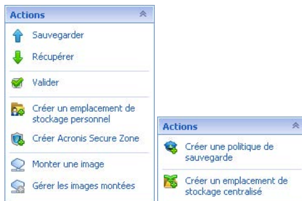
La barre « Actions » sur une machine gérée et sur un serveur de gestion
